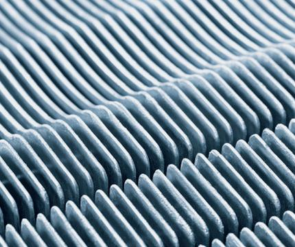
Primo piano delle alette dello scambiatore di calore della caldaia murale Hoval TopGas® classic, combi e comfort. La speciale struttura dello scambiatore di calore con tubo di rame a circolazione forzata impedisce intasamenti, è facile da pulire e offre un trasferimento di calore ottimale.
