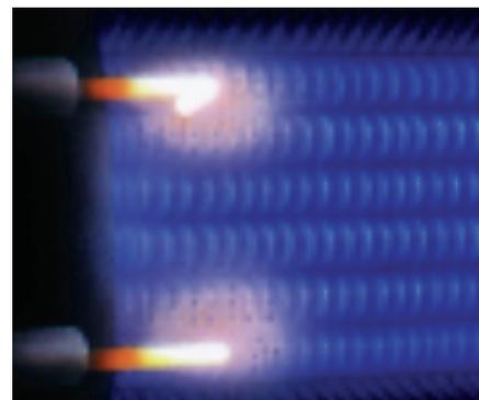
Bruciatore in rete metallica per una temperatura di combustione ottimale per emissioni ridotte al minimo.
